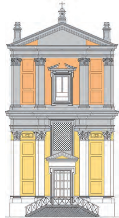
Fig. 2.32 – Facciata della Chiesa nella quale sono messi in evidenza i materiali utilizzati.
